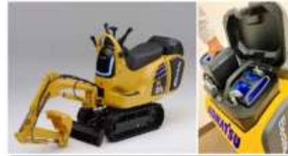
鉱山機械の電動化
