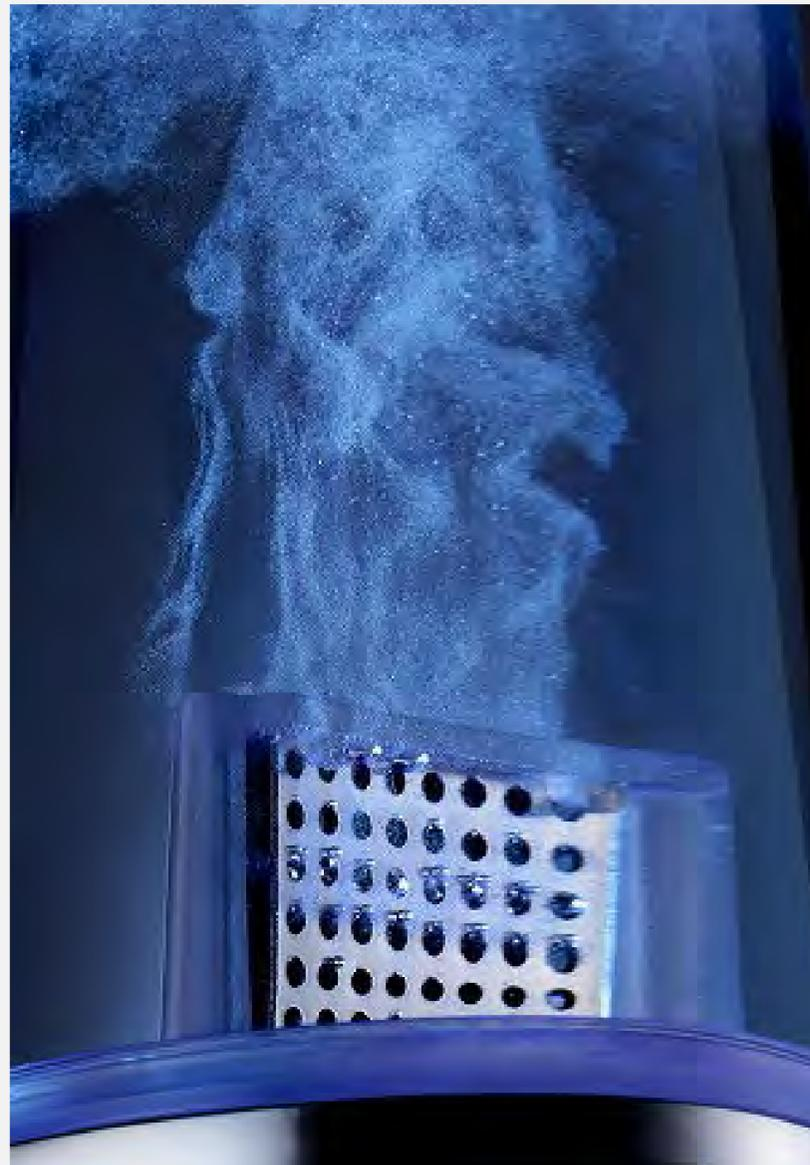
独自に開発したコアテクノロジー「EOCIS」（イオシス）は内部に組み込まれた特殊電極に最適な電圧をかけ、水道水を電気分解することによって、除菌効果を持つ物質を複数生成すると同時にファインバブルを発生させるMTG独自の技術。特殊電極にはチタン、ステンレスをベースに、白金系の金属など複数素材を独自の配合比率でコーティングしている。
