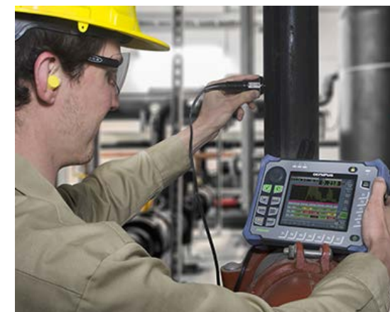
プラント配管検査
