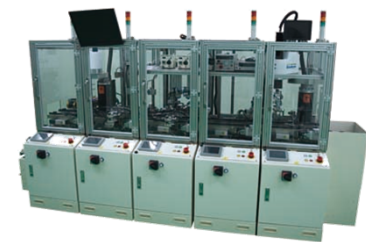
モジュール自動化ライン (組立・検査のモジュール化)
