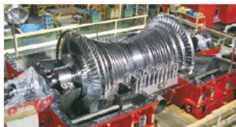
蒸気タービン
