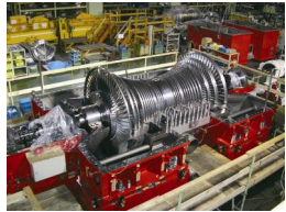
蒸気タービン
