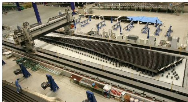
スキン用ウォータージェット切断装置(増設)
